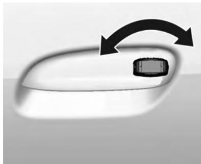
Para veículo equipado com trava elétrica das portas, gire a chave no sentido anti-horário. Todas as portas serão travadas. Para veículo sem trava elétrica das portas, gire a
