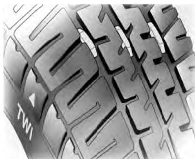
A profundidade mínima legalmente admissível da banda de rodagem (1,6 mm) foi alcançada quando a banda ficar desgastada até um dos indicadores de desgaste (TWI). Suas posições são indicadas por marcas na parede lateral.
