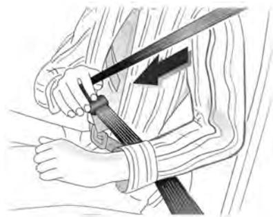
Retire o cinto da bobina, conduza-o pelo corpo, sem torcer, e empurre a lingueta de acoplamento na fivela até que encaixe. Tensione o cinto subabdominal regularmente ao dirigir puxando o cinto diagonal sobre o ombro.
