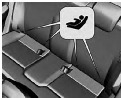
2. Localize as duas posições de ancoragem inferiores. A localização de cada âncora inferior é identificada por uma marca circular na borda inferior do encosto do banco traseiro.
